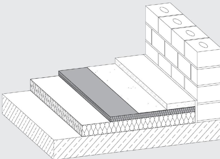
Begehbare Steinwolle-Dämmplatte\* für die Trittschall-, Luftschall- und Wärmedämmung von Geschossdecken und Böden unter schwimmenden Mörtel- und Fließestrichen.
